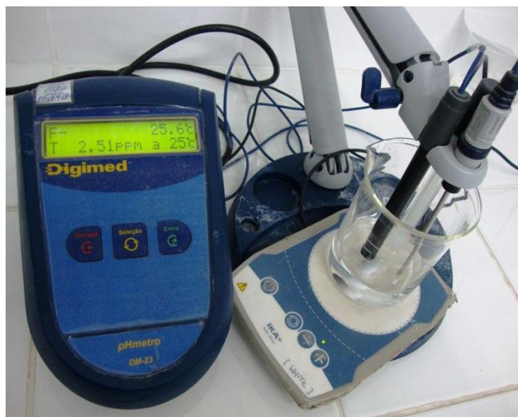
Figura 4.13 - Phmetro e eletrodo seletivo para análise de flúor, (Tecnosulfur, 2012).
