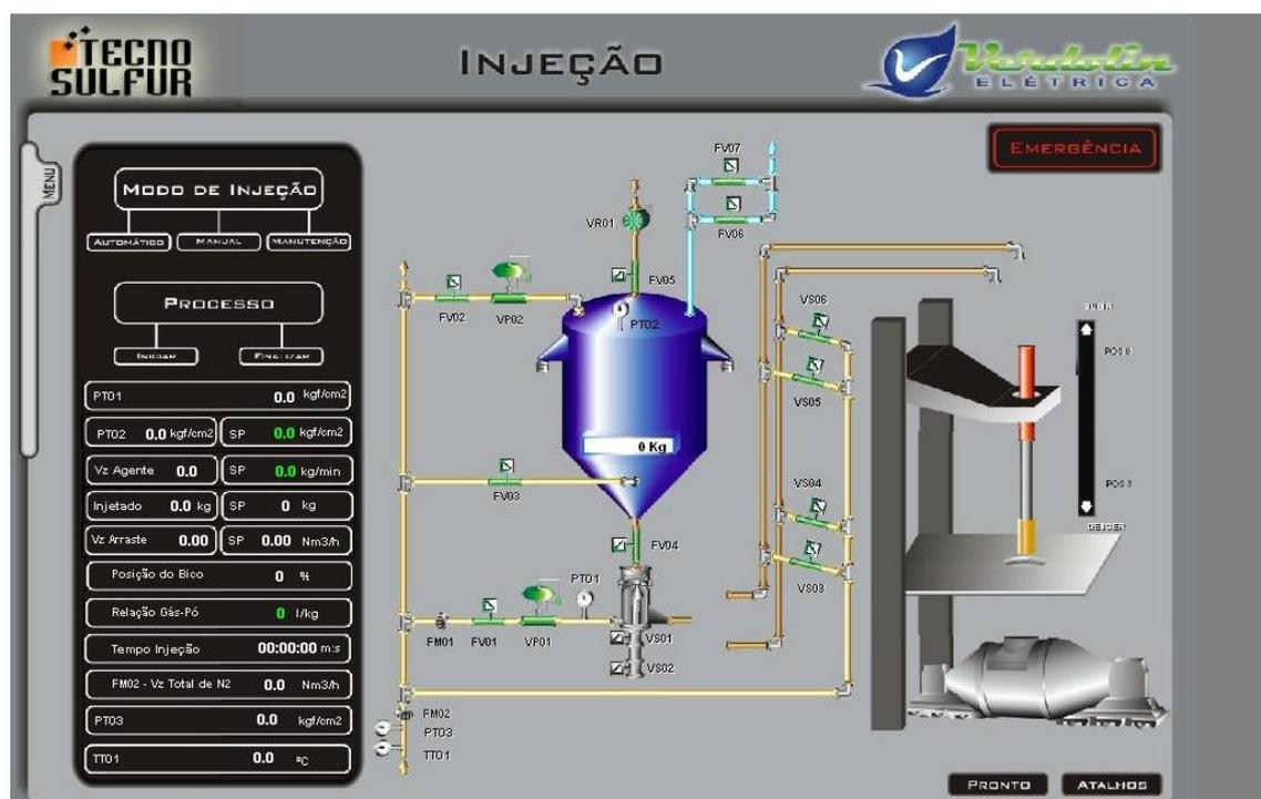
Figura 4.4 - Sistema Supervisorio da estação de dessulfuração,(Tecnosulfur,2012).
