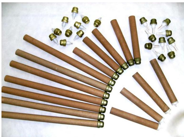
Figura 4.11 - Lanças termopares utilizadas para coleta de amostra de ferro-gusa para medição de temperatura e análise de enxofre.
