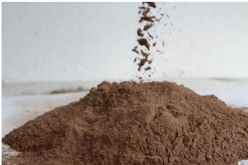
Figura 4.6 - Agente Dessulfurante Micropulverizado à base de carbureto de cálcio (Tecnosulfur/2012)
