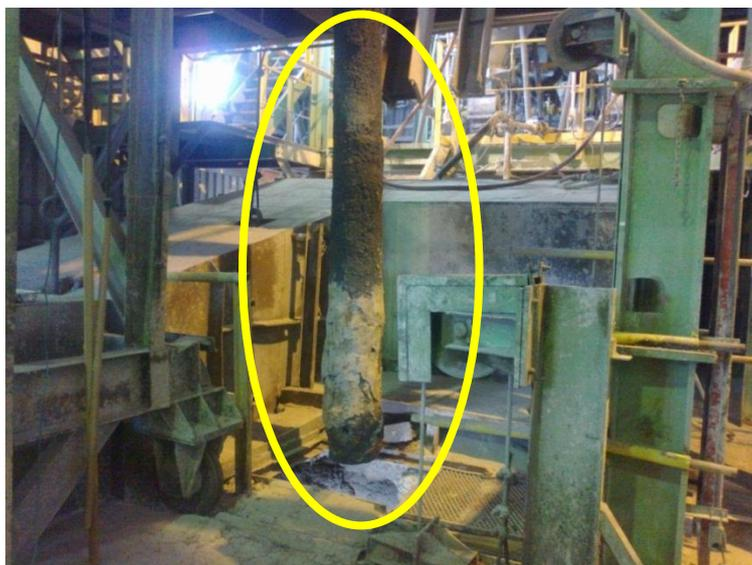
Figura 4.12 – Lança utilizada na estação de dessulfuração.
