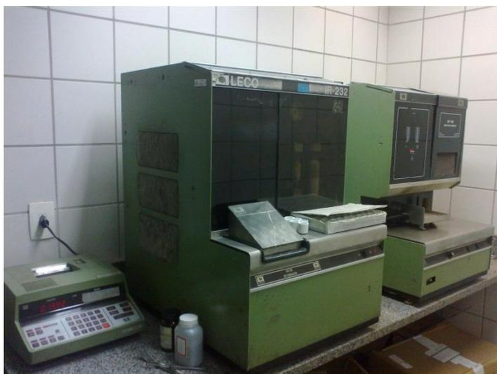
Figura 4.10 - Aparelho Leco utilizado para realização das análises de enxofre durante o experimento.
