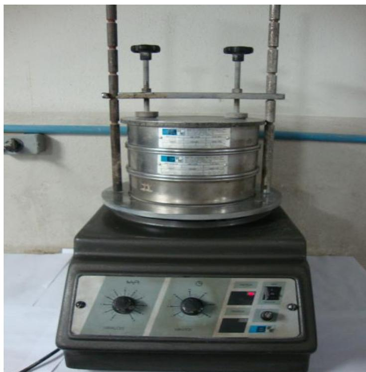
Figura 4.15 – Agitador granulométrico, (Tecnosulfur, 2012).
