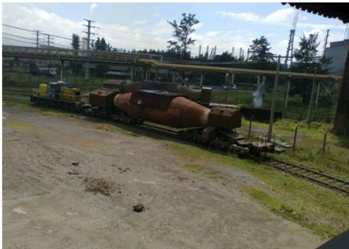
Figura 4.1 - Carro torpedo com revestimento refratário dolomítico.
