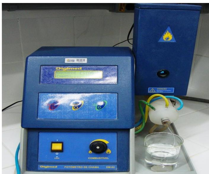
Figura 4.14 - Fotômetro de chama utilizado para análise de  $Na_2O$  e  $K_2O$ , (Tecnosulfur, 2012).
