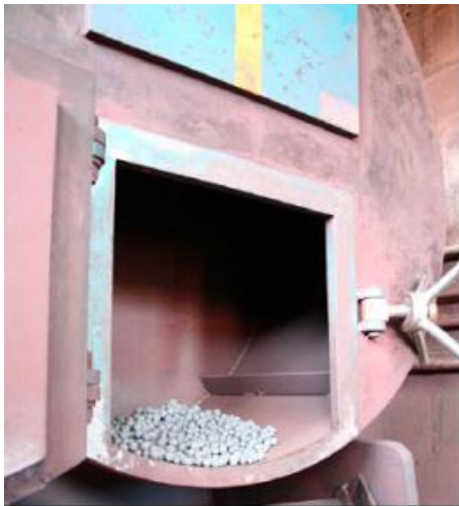
Figura 4.4 – Ensaio de simulação das operações de manuseio das pelotas, utilizando um tambor de abrasão.
