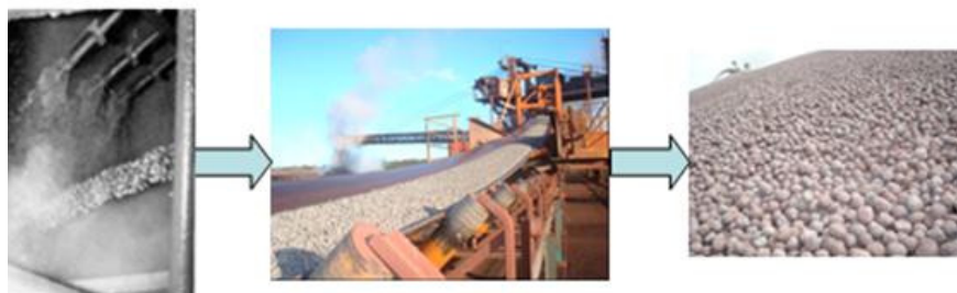
Figura 3.13: Sistema industrial de aspersão do revestimento com calcário e bentonita em pelotas de redução direta .
