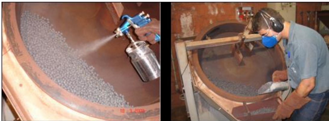
Figura 4.3 – Aspersão da solução com uso de pistola de ar comprimido e disco de pelotamento.
