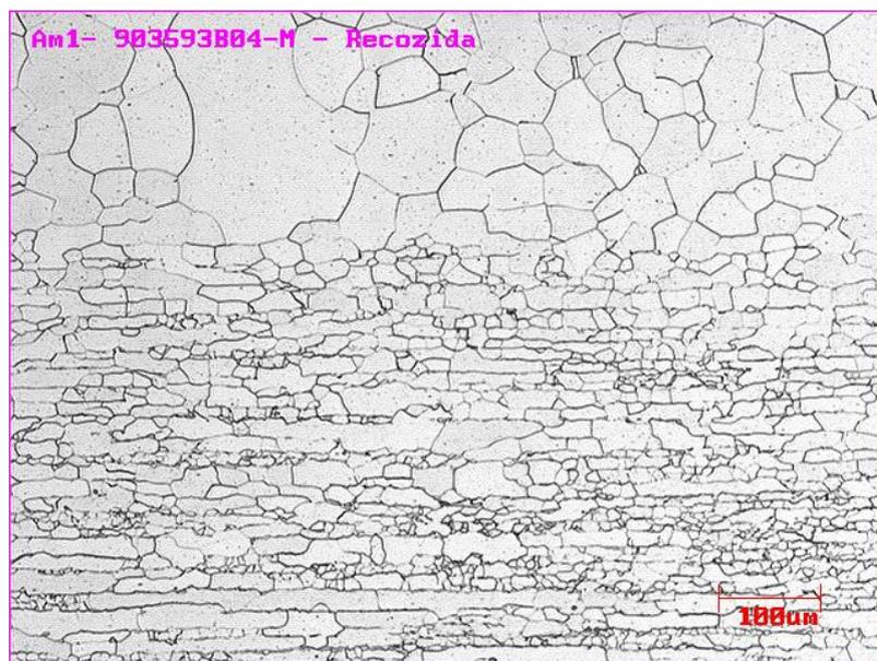
Figura 5.4 - Micrografia da amostra após recozimento inicial. Seção paralela à direção de laminação. Ataque nital 5 %. Fotografado com 100 X.
