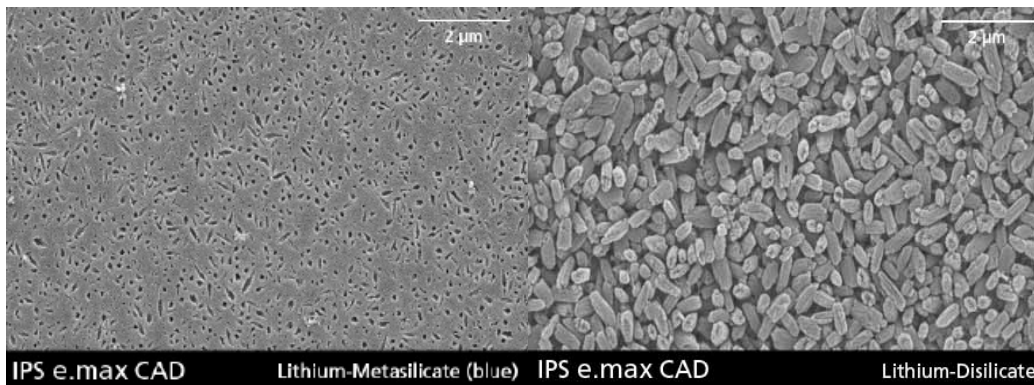
Fig 41 - Microscopia eletrônica do bloco parcialmente cristalizado a esquerda e totalmente cristalizado à direita. Fonte: Ivoclar
