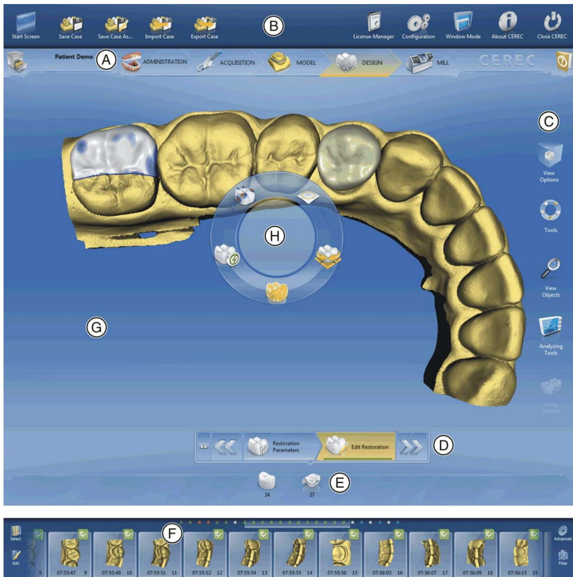
Fig 13 - Tela principal do programa CEREC SW4..0 onde se vê o modelo virtual com as restaurações propostas e todas as fases da produção estão disponíveis ao usuário. Fonte: Sirona
