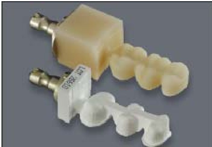
Fig. 63 - Fresagem finalizada em branco da subestrutura zircônia e da supra-estrutura em amarelo.
