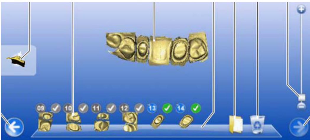
Fig.14 - Catálogo de imagens obtidas durante a fase de aquisição onde se vê no alto o modelo virtual correspondente ao somatório das imagens. Fonte: Sirona
