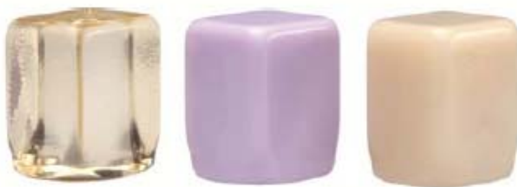
Fig 38 - Diferentes estágios do e.max CAD : bloco de vidro , parcialmente cristalizado ( azul) e totalmente cristalizado ( dissilicato de lítio ) resistência 360 MPa . Fonte:Ivoclar
