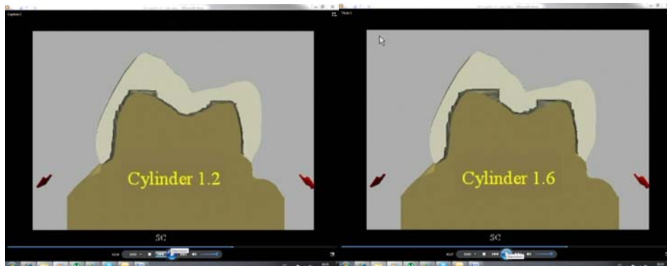
Fig. 126 - Adaptação interna de uma Coroa Cerec fresada por uma broca de 1.2 mm e de 1.6 mm, onde se observa uma melhor adaptação na da esquerda. Fonte: Sirona.
