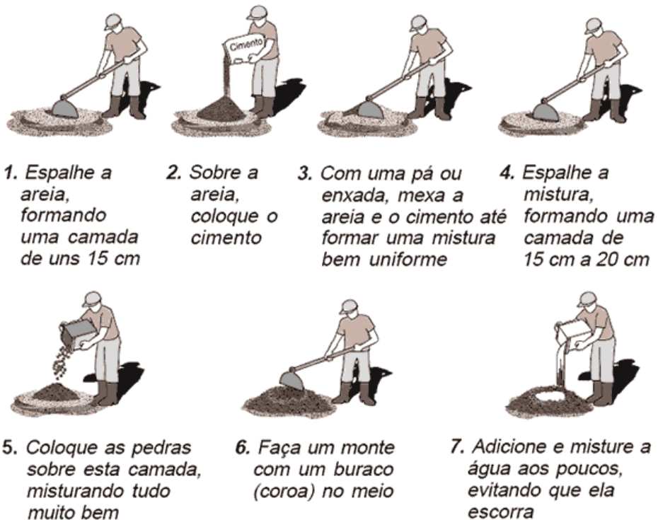
Figura 5.4 – Passo-a-passo para mistura de concreto. Fonte: www.fazfacil.com.br/reforma-construcao/tracos-concreto-mistura/
