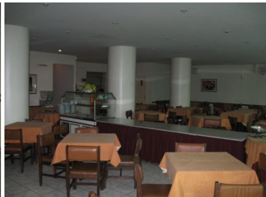
FOTO 17 E 18: ACESSO RESTAURANTE (INTERNO) – PISO EM CERÂMICA (COR: BEGE - DIVERSOS MODELOS); RODAPÉ EM GRANITO (COR: BEGE) PAREDES EM MASSADAS E PINTADAS (COR: BRANCO); PORTA VIDRO TEMPERADO COM PUXADORES METÁLICOS. ACESSO SANITÁRIO (MASCULINO E FEMININO) – PORTAS MADEIRA PINTADAS – FOTOS PELA AUTORA – 09/2011.
