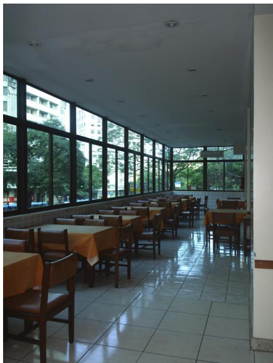
FOTO 19: RESTAURANTE – PISO EM CERÂMICA (COR: BEGE - DIVERSOS MODELOS); RODAPÉ EM GRANITO (COR: BEGE) PAREDES (PEITORIL INTERNO) EM CERÂMICA PORTUGUESA; FECHAMENTO EM ESQUADRIA METÁLICA (COR: MARROM). FOTOS PELA AUTORA – 09/2011.
