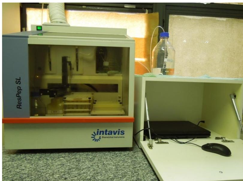
**Figura 8** – Foto do sintetizador automático ResPep Automatic Spot Synthesizer, da Intavis, utilizado para a síntese de peptídeos em membrana de celulose e para a síntese solúvel de peptídeos.
