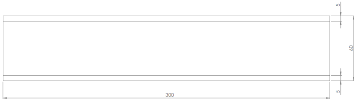
FIGURA 24 – Os corpos de prova são desfiados 5mm das laterais mais extensas.
