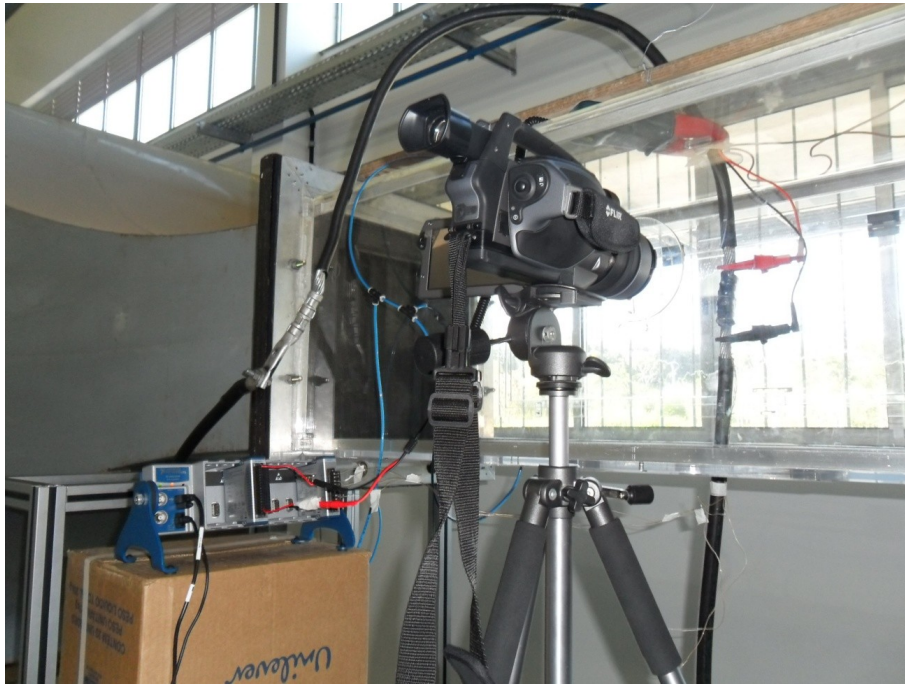
Figura 4.6: Posicionamento da termocâmara para o registro dos termogramas.
