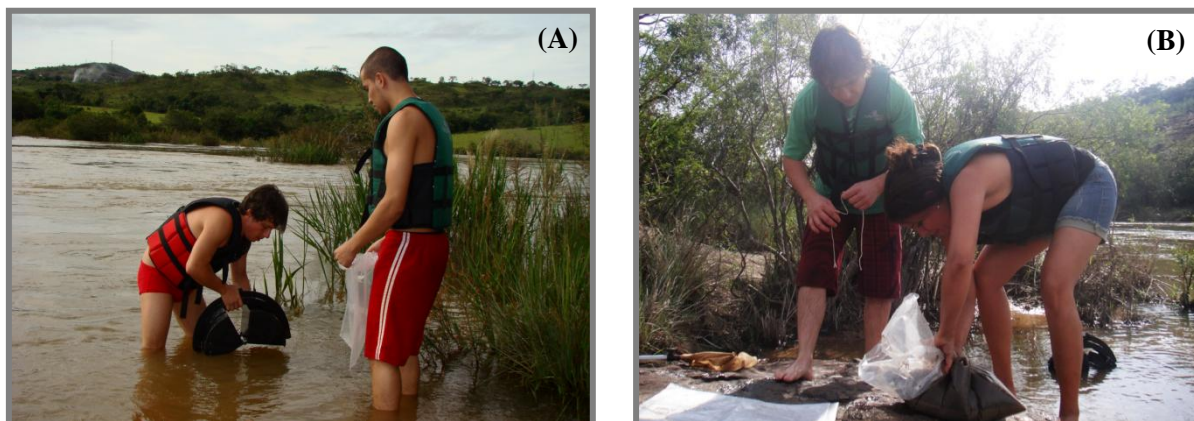
Figura 11. Detalhes das amostragens de sedimento realizadas a jusante do reservatório de Itutinga, Rio Grande, utilizando uma draga de Petersen. (A) Coleta do sedimento com a draga; (B) ensacamento das amostras.
