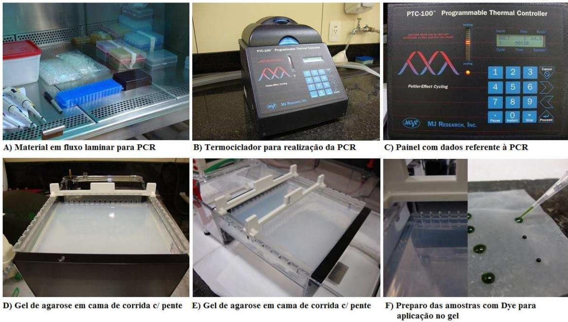
FIGURA 13 - Imagens da execução da corrida de eletroforese em gel de agarose
