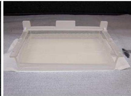
B) Gel de agarose em cama de corrida com pente para formação dos poços onde são aplicadas as amostras
