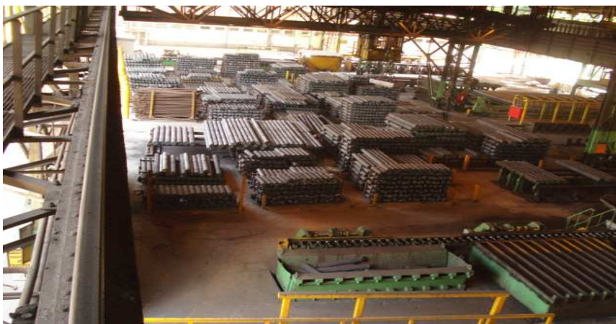
Figura 18 – Pilhas de blocos de aço processados no Galpão da ajustagem do Lingotamento Contínuo
