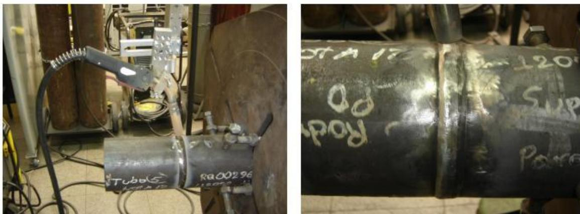
Figura 4.3: Montagem utilizada para mecanização da soldagem.
