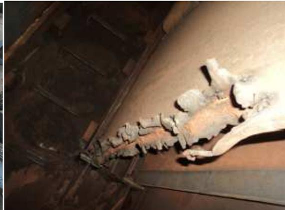
Figura 53. Eletrodo com desgaste.
