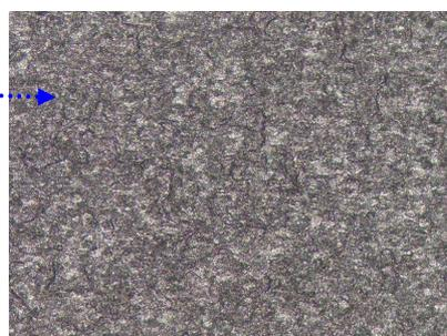
**Figura 27. Microscopia óptica fora do defeito.1x53**
