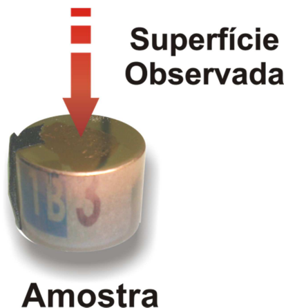
Figura 4.16 – Superfície plana observada no MEV para medição de espessura. Diâmetro = 25,4mm
