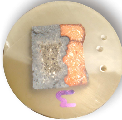
Figura 4.18 - Corpo de prova inutilizado devido à grande penetração de resina em seu interior.
