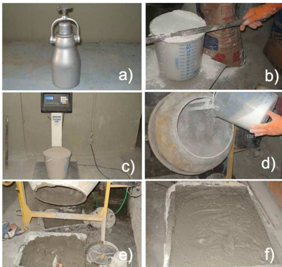
Figura 4.3 - Processo de execução das argamassas. a) método Speed; b) dosagem dos materiais; c) pesagem dos materiais; d) mistura; e) descarga da argamassa; f) descanso da argamassa.
