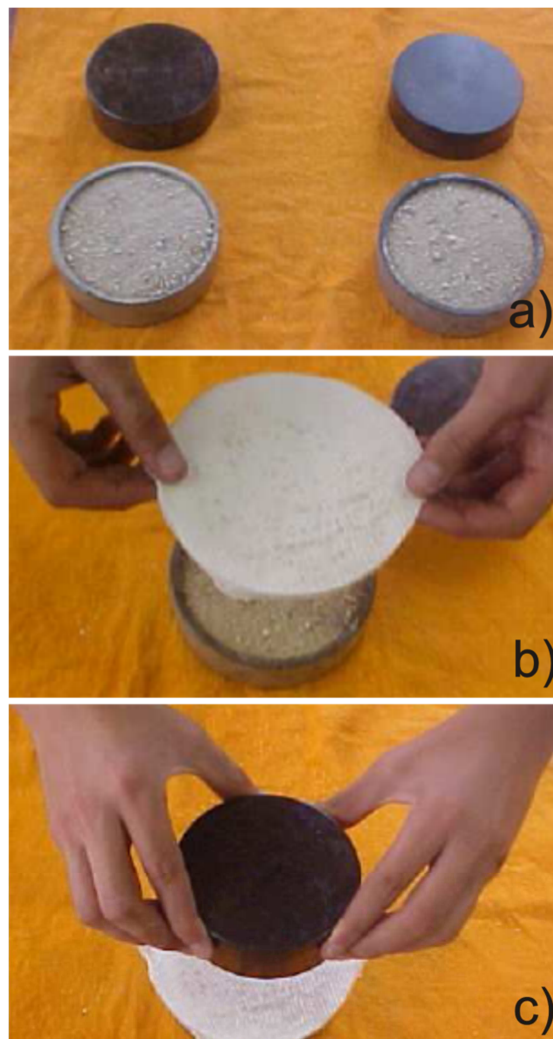
Figura 4.6 - Ensaio de retenção de água: a) moldes com argamassa e peso cilíndrico de 2kg; b) posicionamento do conjunto de papéis filtro sobre o molde com argamassa; c) posicionamento do peso cilíndrico sobre o conjunto para realização do ensaio.
