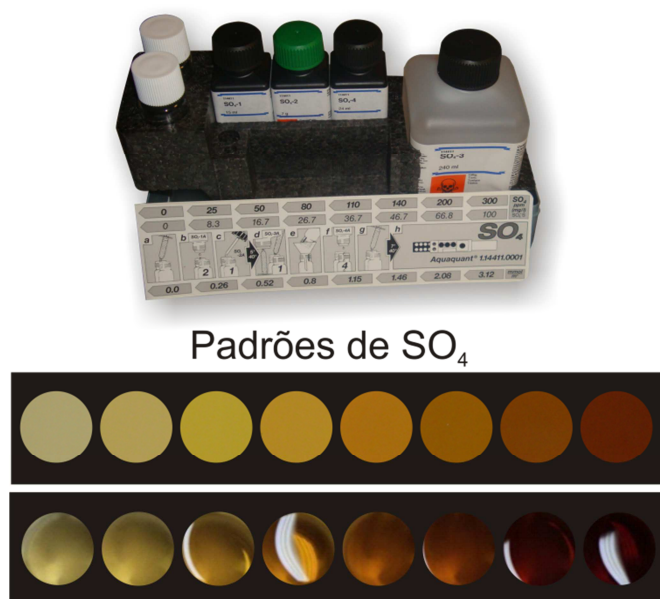
Figura 4.31 – Teste para análise de \text{SO}_4 em solução.
