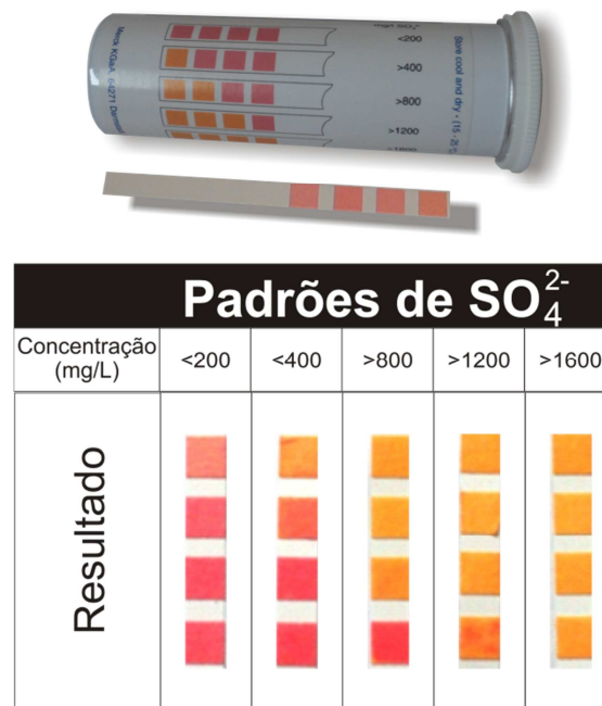
Figura 4.30 – Teste para análise de \text{SO}_4^{2-} em tiras.
