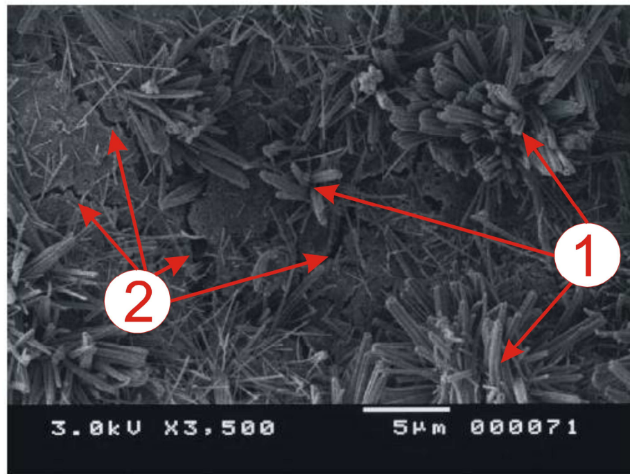
Figura 3.8 - Fotomicrografia da interface tijolo/argamassa no MEV- IES, onde se podem ver cristais típicos de etringita (1), responsável pelo intertravamento, saindo de dentro de microfissuras do bloco (2).
