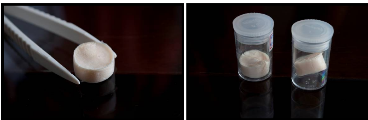
Figura 5.10: Imagens obtidas por fotografia ótica das matrizes de quitosana e vidro bioativo com dimensões de 10 mm x 18 mm.
