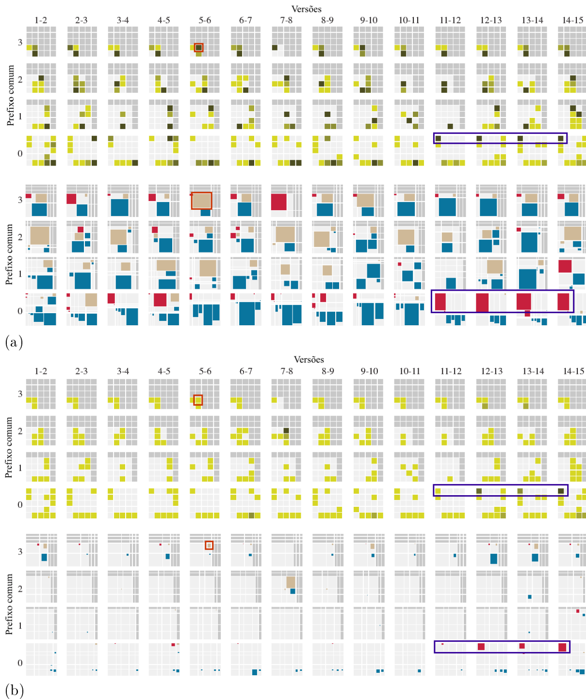
Figura 4.5: (a) Heatmap e Quadmap com escala linear, somente mudanças exibidas e normalização local. (b) Heatmap e Quadmap com escala linear, somente mudanças exibidas e normalização global. Em (a) a normalização local destaca mudanças numerosas dentro de cada frame e em (b) a normalização global destaca mudanças numerosas em relação a todo o conjunto de dados considerado.
