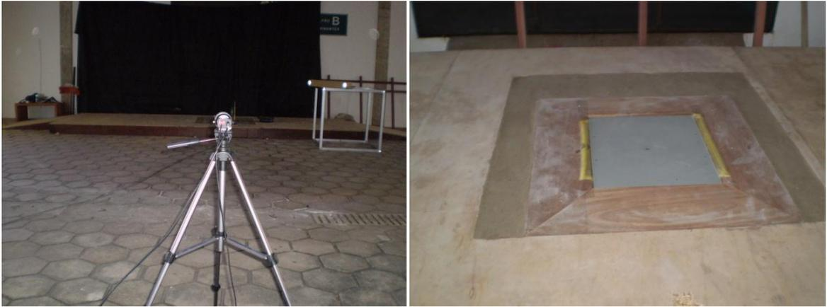
FIGURA 3.4- Equipamentos utilizados para aquisição de dados cinemáticos e cinéticos da marcha dos bezerros na Escola de Veterinária da UFMG. (A) Posicionamento da câmera de vídeo perpendicular ao plano sagital dos animais. (B) plataforma de força ATMI OR6-7 adaptada no centro da passarela.
