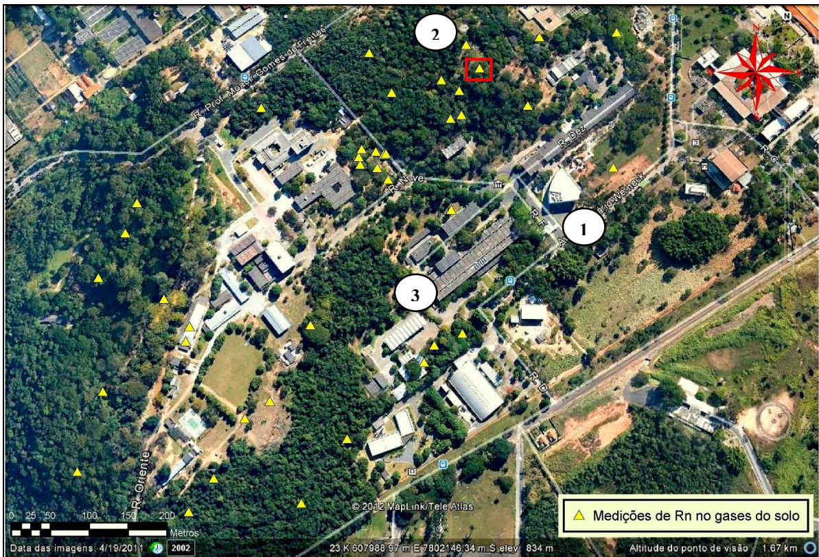
Figura 4-12 - Imagem aérea do CDTN com a localização georreferenciada dos pontos de determinação de radônio nos gases do solo.
