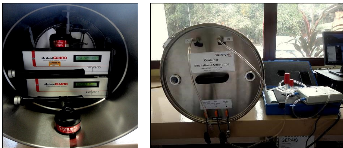
Figura 3-5 - Câmara de calibração aberta contendo dois AlphaGUARD's e duas câmaras de eletretos posicionados (à direita), e câmara de calibração fechada, conectada à bomba AlphaPUMP e à fonte de 226 Ra.
