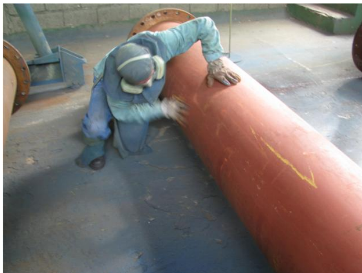
Figura 6. Processo de lixamento de uma peça realizado pelo pintor antes da pintura.
