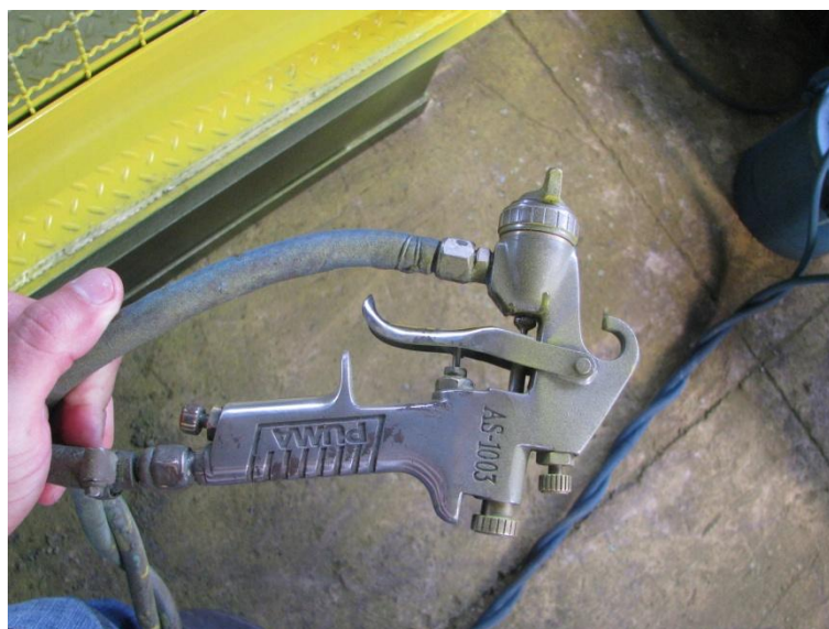
Figura 9. Pistola de tinta que o trabalhador utiliza para pintura.
