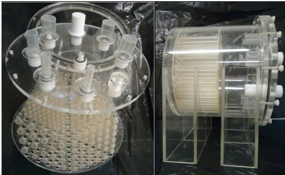
**Figura 28. *Jaszczak<sup>TM</sup> SPECT/PET Phantom Flanged* com uma tampa adaptada demonstrando os cilindros preenchíveis**
