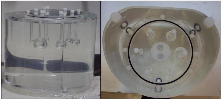
**Figura 18. Simulador *NEMA/IEC Body Phantom* para qualidade de imagem**
