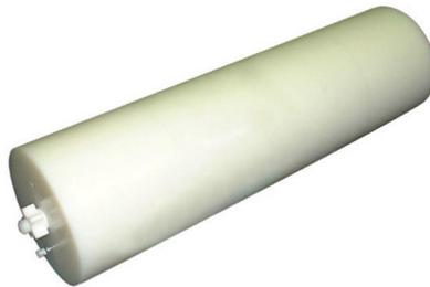
**Figura 15. Simulador NEMA para testes de espalhamento**
