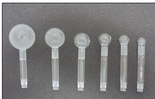
**Figura 27. Compartimentos esféricos preenchíveis do simulador NEMA/IEC
