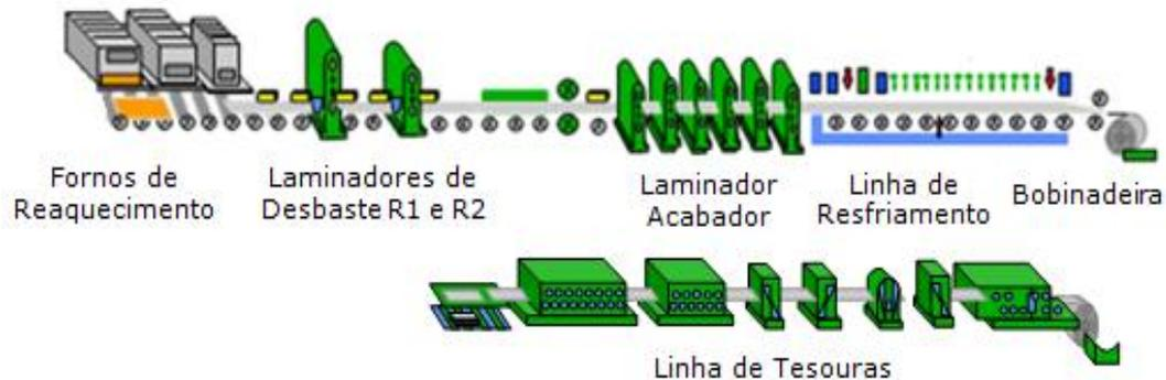
Figura 3.6 - Fluxo de produção do processo de laminação a quente.
