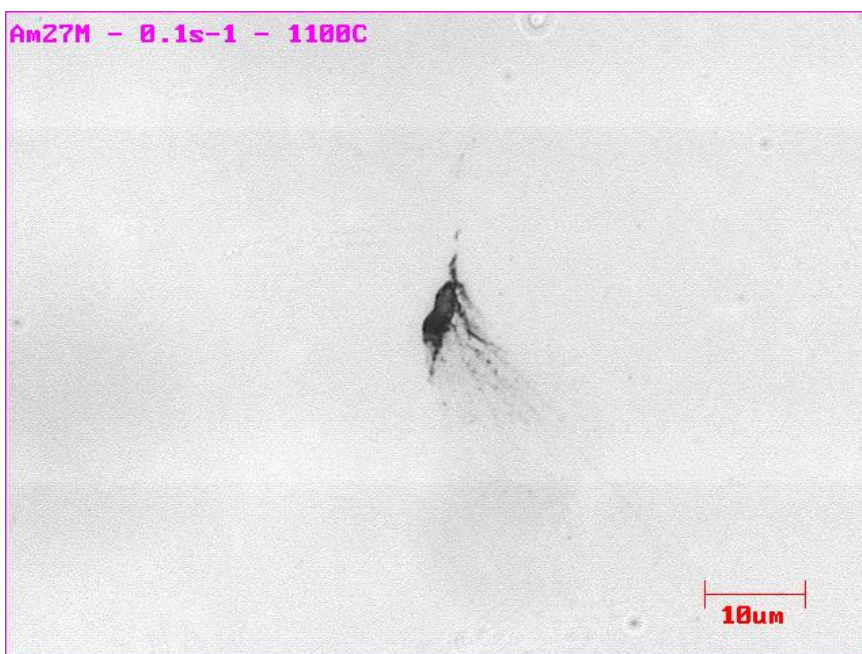
Figura 6.4 – Microtrinca na Tt 1100°C a uma \dot{\epsilon} de 0,1s^{-1} . Sem ataque.
