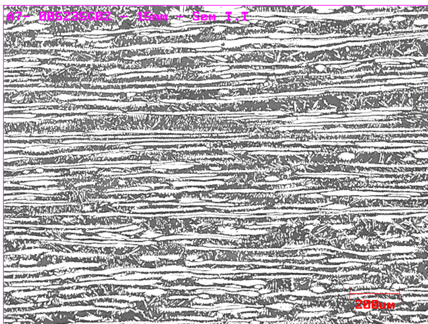
Figura 5.1 - Microestrutura na condição como fornecido. Austenita 48% \pm 30%.
