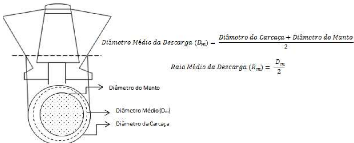
Figura 3.18: Diagrama britadores família giratórios, raio médio.
