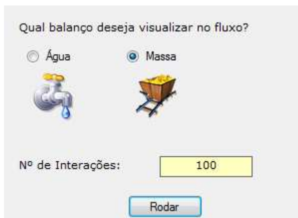
Figura 5.67 - Visualização da localização do botão Rodar no CIC, responsável por fazer o números de interações indicadas na tela (neste caso igual a 100), com o objetivo fazer com que o circuito entre em equilíbrio.
