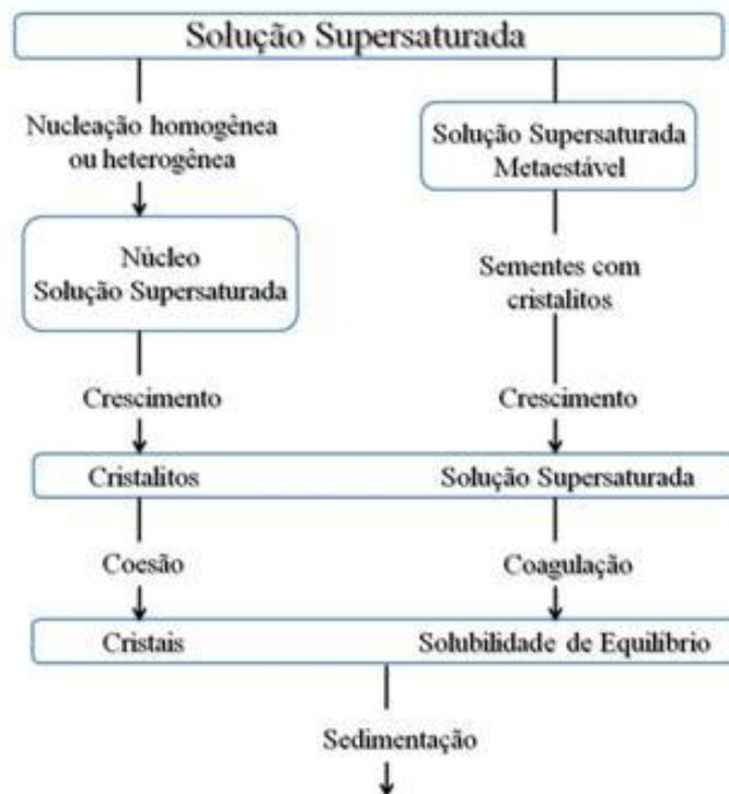
**Figura 3. 7 - Representação esquemática envolvendo a nucleação e crescimento de cristal. Fonte: Stumm (1992).**
