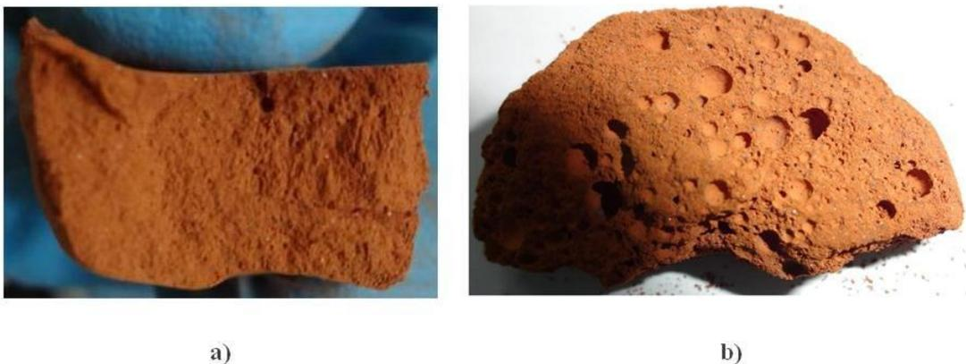
**Figura 5. 22- Estrutura do geopolímero a base de lama vermelha: a) Sem SPL, b) Com SPL (15%*m*).**
