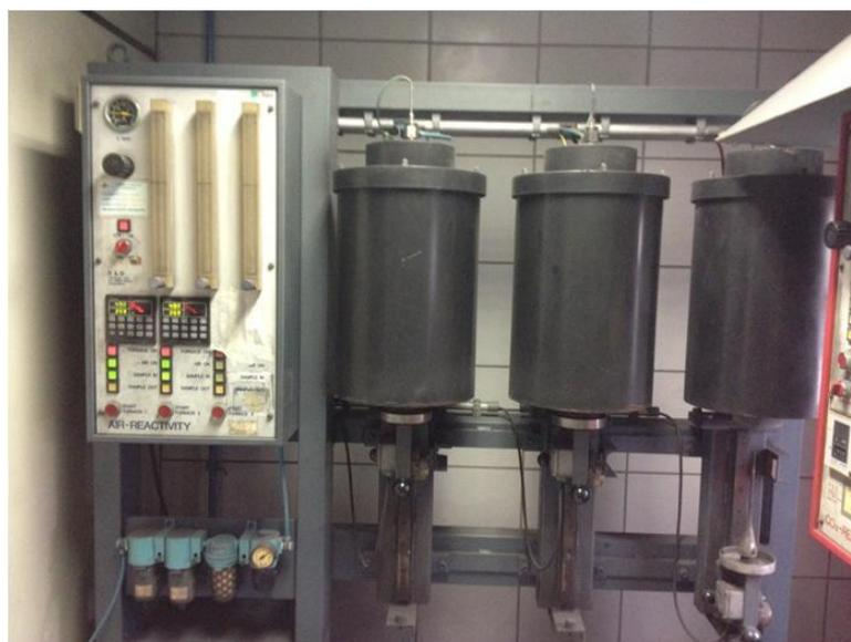
**Figura 4. 2- Forno de atmosfera redutora.**
