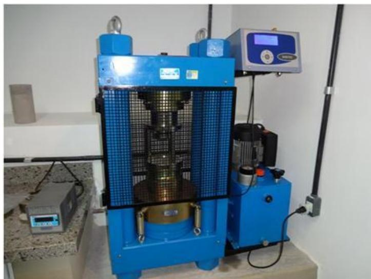
**Figura 4. 4- Equipamento de ensaio mecânico de compressão uniaxial.**
