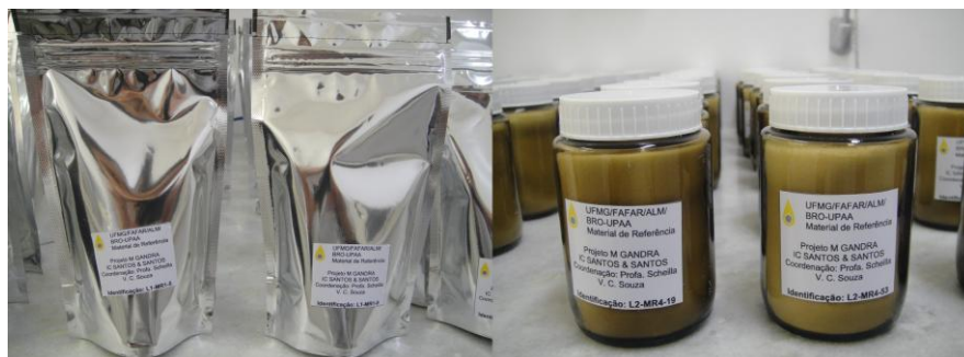
Figura 6. Materiais de referência de leite em pó integral acondicionados em sachês tipo stand-up pouch de 100 g de politereftalato de etileno metalizado/polietileno de baixa densidade com zíper e selados termicamente e em frascos de vidro âmbar de 100 g com tampa de rosca.
