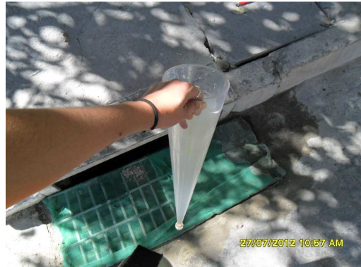
Realização de teste Imhoff.
