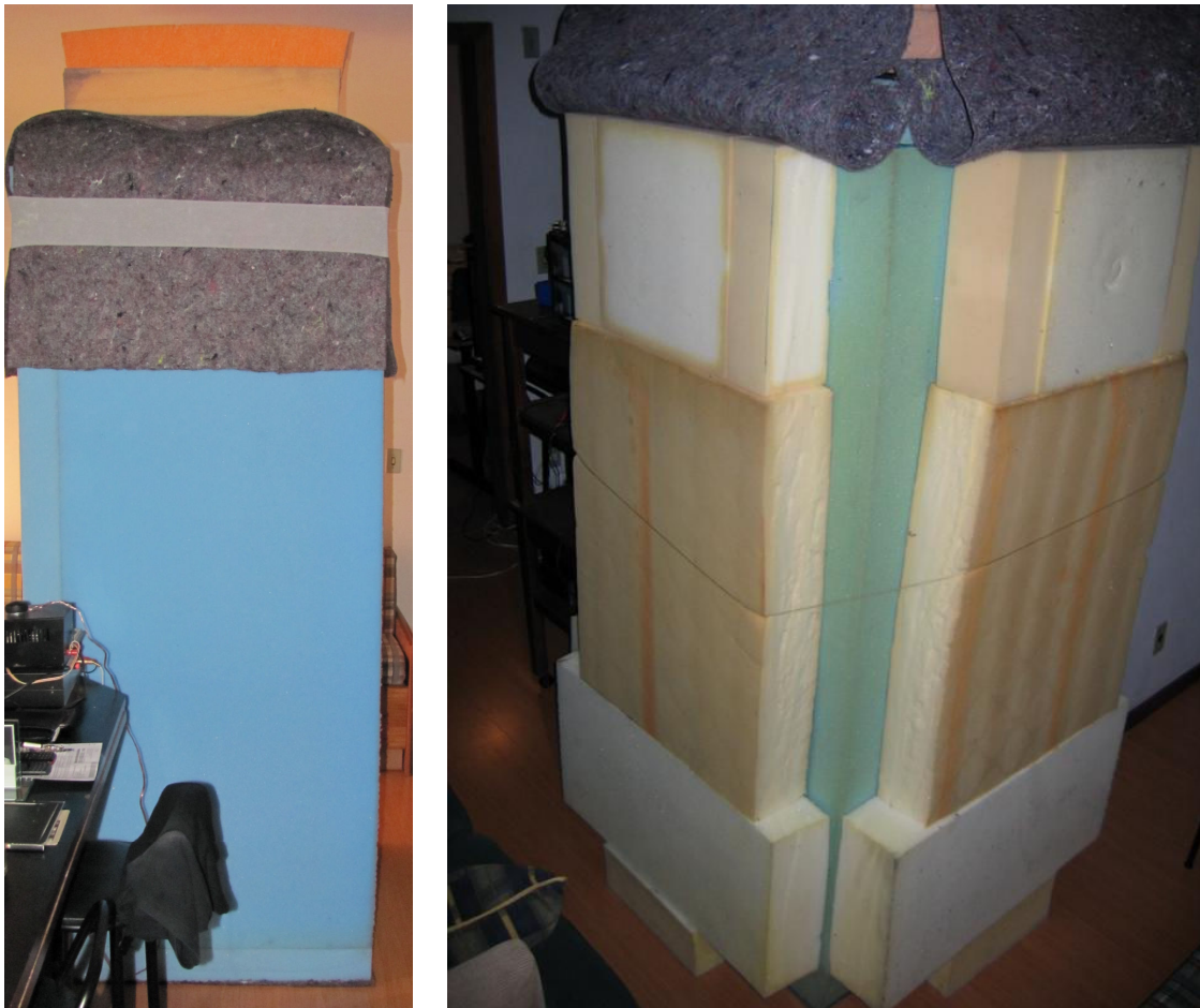
FIG. 3.13a - Montagens da câmara acústica com 1 camada (esq.) e 2 camadas (direita).
