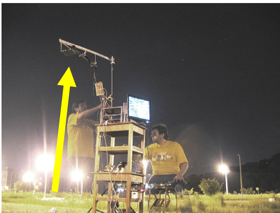
FIG. 3.16b - Calibração em campo aberto, a seta indica visada direta entre tweeter e a matriz.
