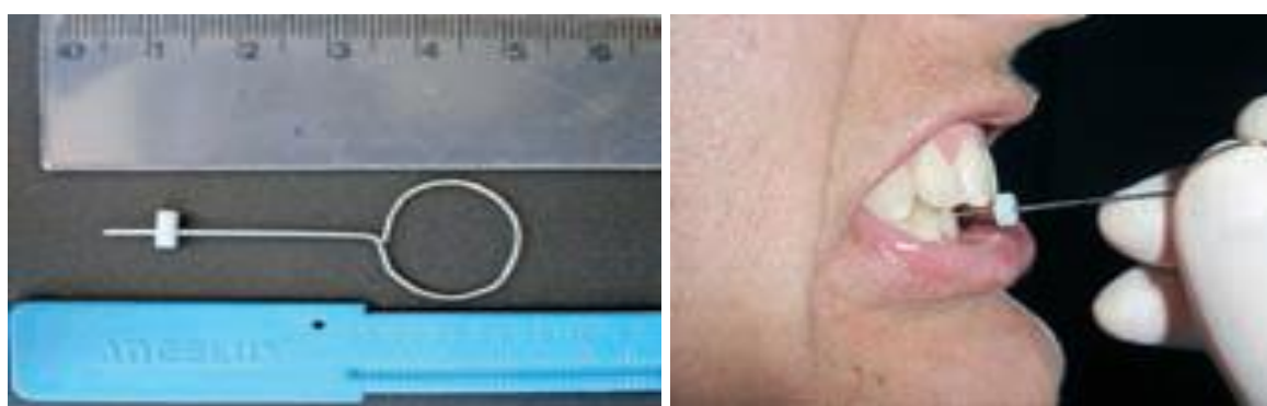
Figura 4 - Instrumento alternativo de medida do DAI com cursor introduzido de 2 a 5 mm da extremidade. A- circunferência; B- parte reta do instrumento; C- cursor; D- régua milimetrada endodôntica; e E- régua milimetrada comum.
