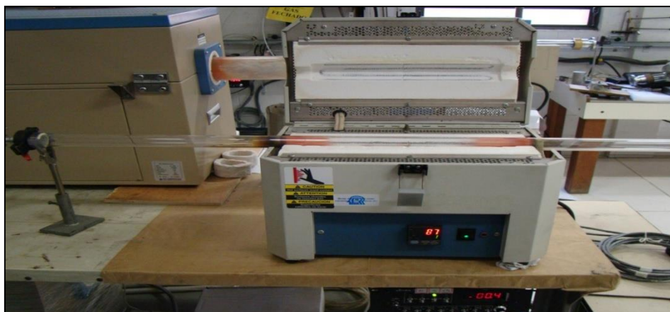
Figura 23: Forno LINDBERG/BUE utilizado para o crescimento.
