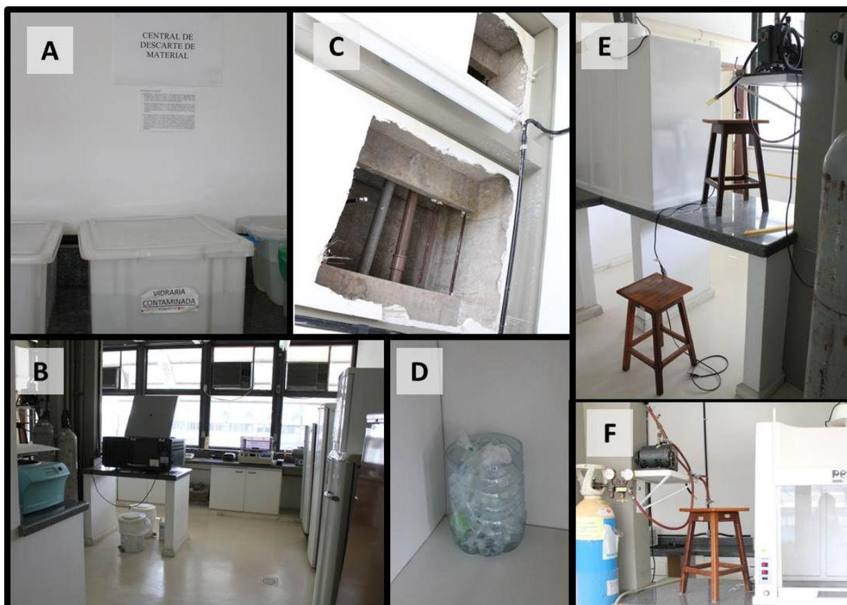
**FIGURA 3.** Laboratório de Uso Coletivo 1 do DMVP. Em (A) Descarte de material; (B) Visão geral; (C) Teto com aparente risco de queda; (D) Descarte de material não identificado; (E) Bomba de vácuo com fio remendado; (F) Bomba de vácuo de difícil acesso e manipulação.
