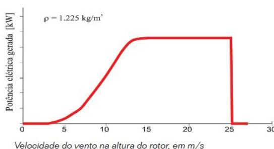
Figura 2.6: Curva típica de potência de turbinas eólicas
