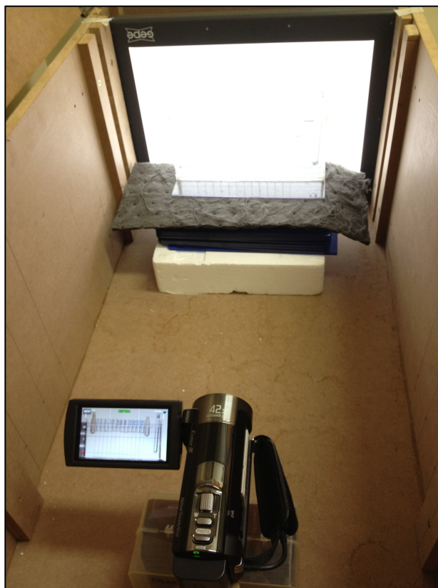
Figura 16. Caixa de comportamento de flotação (madeira compensada; 28 cm x 78 cm x 37 cm). Na foto, pode-se observar o negatoscópico como fonte de iluminação e a câmera filmadora fixada.
