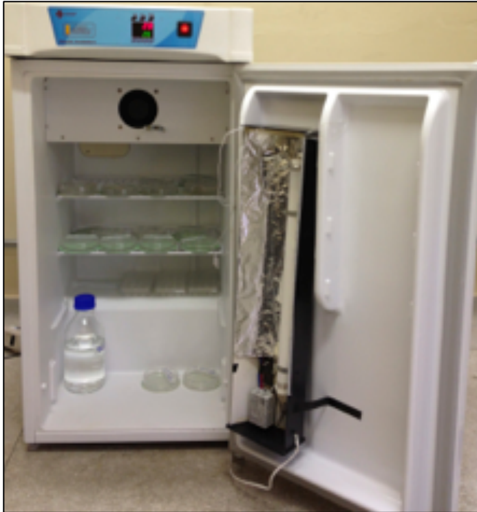
Figura 12. Incubadora (estufa mini-incubadora microprocessada para B.O.D – QUIMIS - Modelo Q315M13). Embriões e larvas foram incubados em temperatura controlada (28°C) com ciclo de luz de 14-10h.
