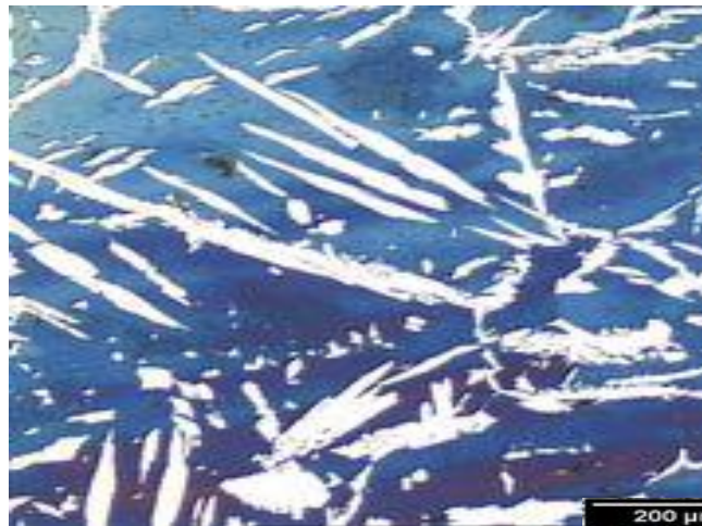
(a) GMAW 2209 ZTA Raiz da solda 100x antes dos ensaios eletroquímicos.
