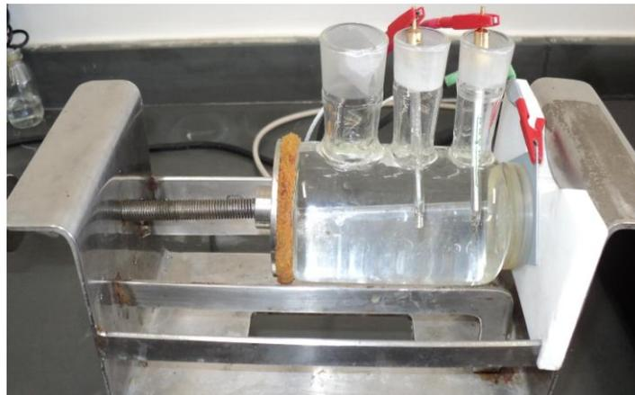
**FIGURA 9-** Apresentação da célula utilizada no experimento.
