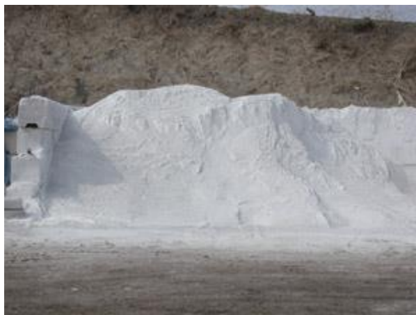
Figura 12 – Gesso proveniente da reciclagem de drywall pronto para utilização na Califórnia
