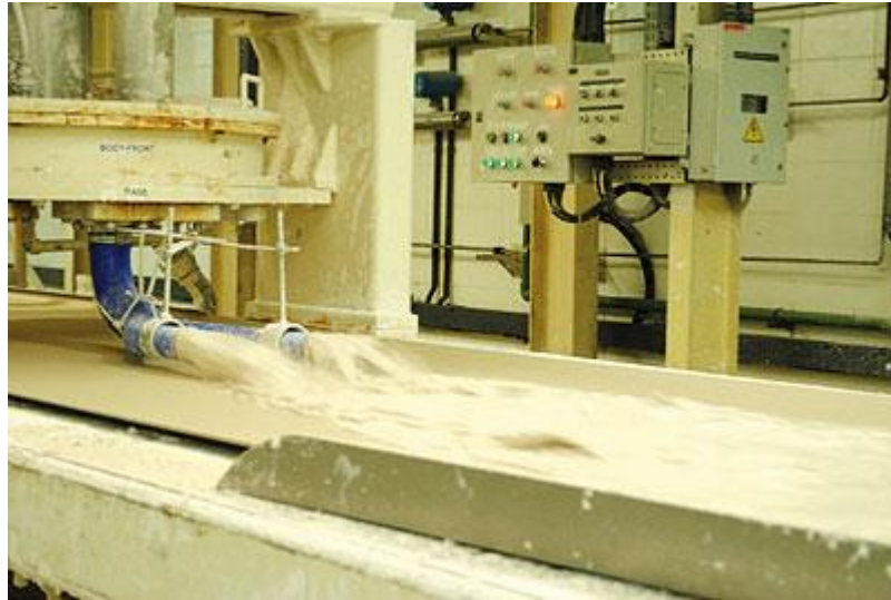
Figura 3 – O gesso em pasta é lançado sobre o papel cartão
