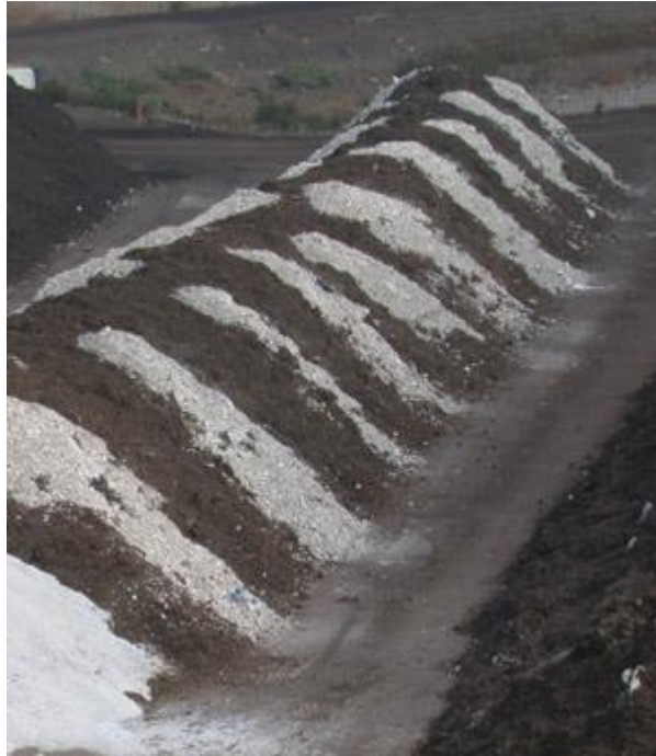
Figura 14 – Leiras em processo de compostagem com adição de resíduos de drywall
