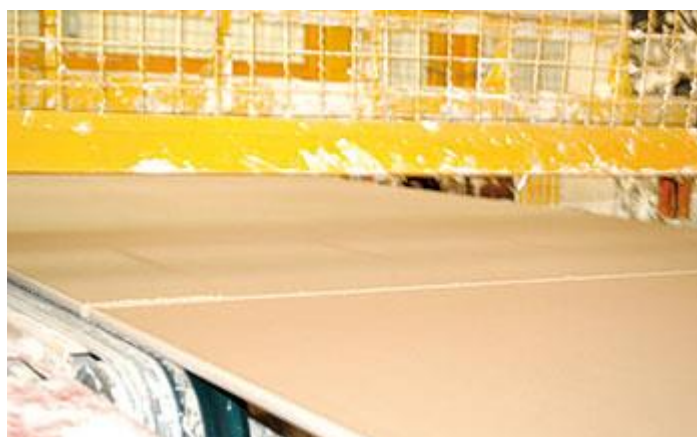
Figura 6 – As placas são cortadas conforme os padrões do mercado
