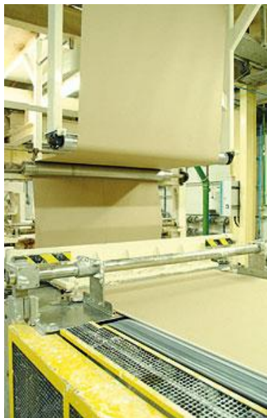
Figura 5 – Ainda na extrusora, uma segunda folha do papel cartão é adicionada
