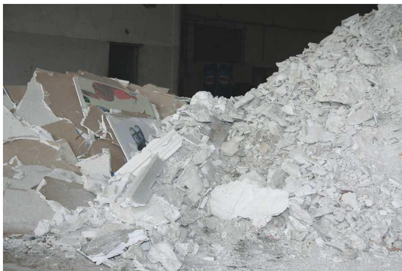
Figura 11 – Segregação dos resíduos de gesso
