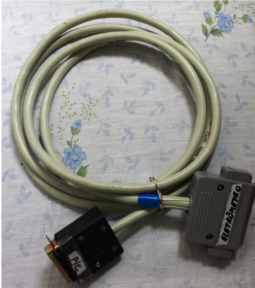
**Figura 41** – Cabo de interconexão do eletrômetro à PCI com o PIC16F877A.
