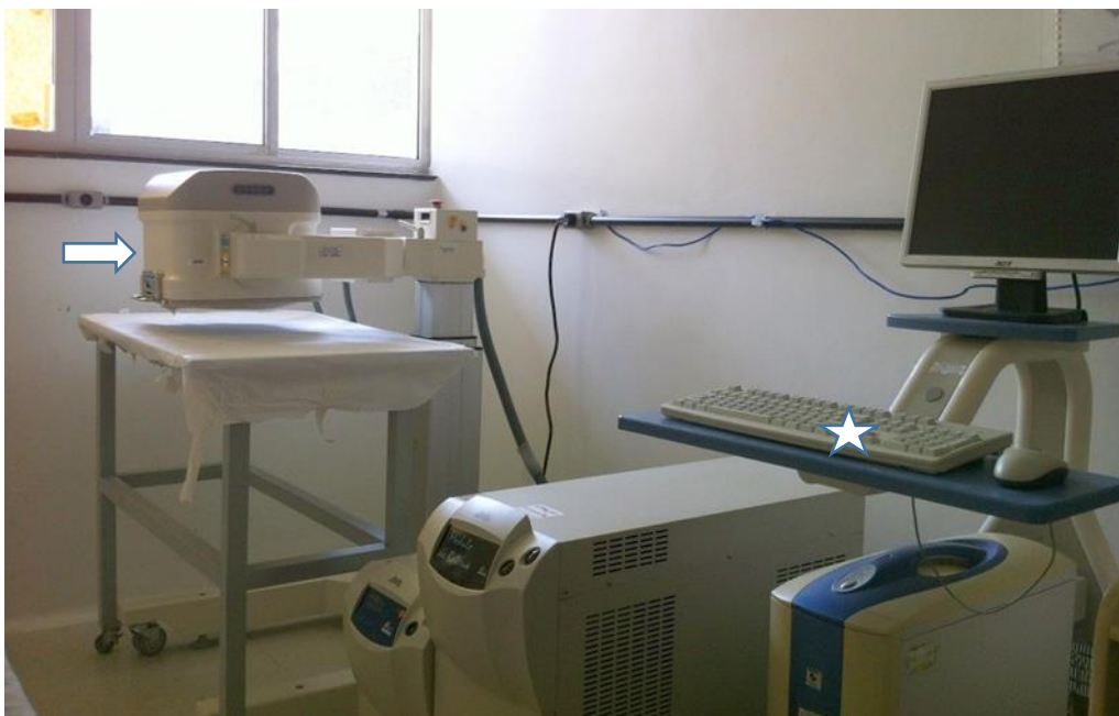
FIGURA 7: Aparelho de gamacâmara (seta) acoplada a computador (☆) no Laboratório de Radioisótopos da Faculdade de Farmácia da UFMG.
