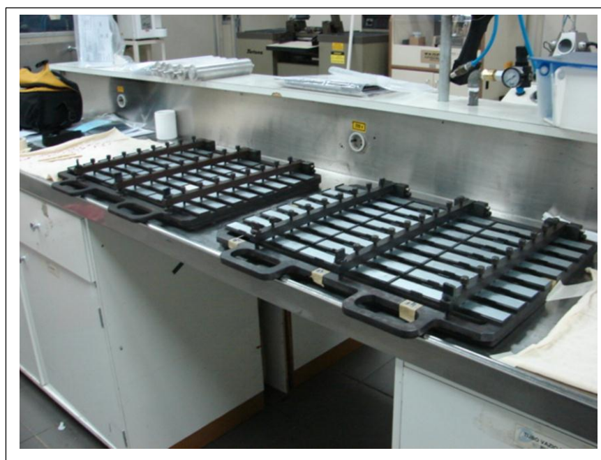
FIGURA 67 – Detalhes do dispositivo fechado com os corpos de prova. FONTE – LAB. FIAT
