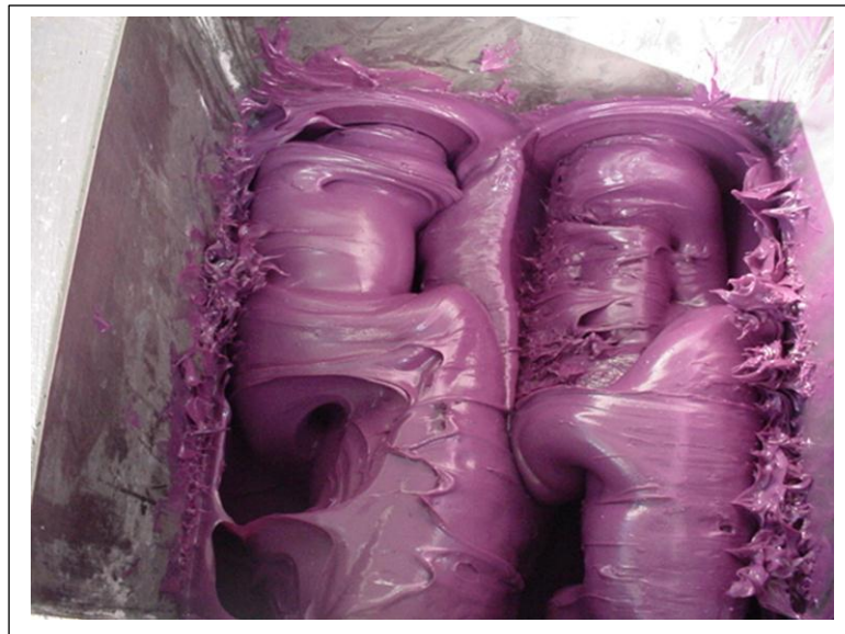
FIGURA 50 - Misturador Sigma Mixer com a mistura com 0,25% de nanografite. FONTE - LAB. SIKA
