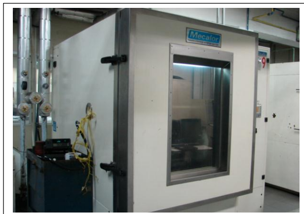
FIGURA 56 – Câmara climática MECALOR – Vista Geral.
