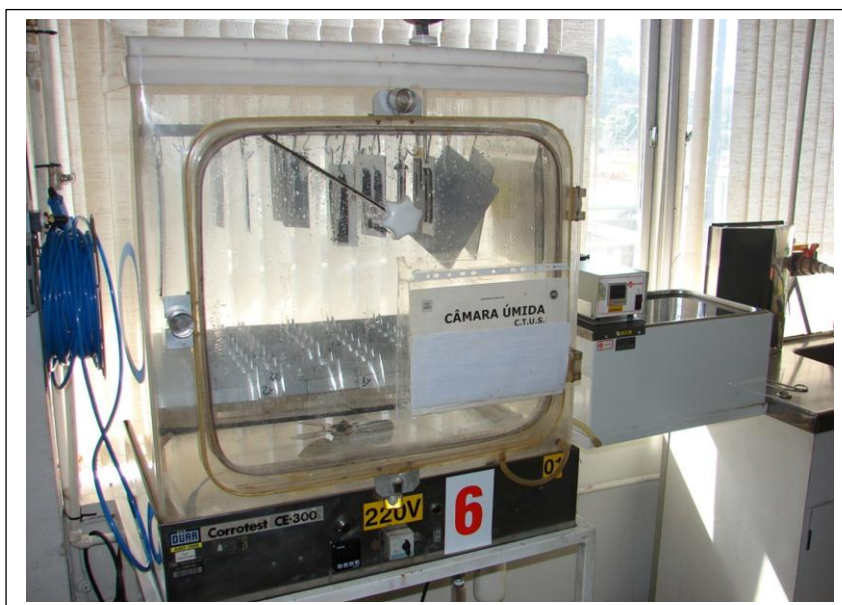
FIGURA 75 – Vista geral da câmara úmida – fabricante Corrotest CE300
