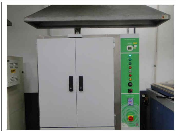
FIGURA 82 – Estufa do fabricante Ethik Technology usada para o processo de cura FONTE – LAB.FIAT
