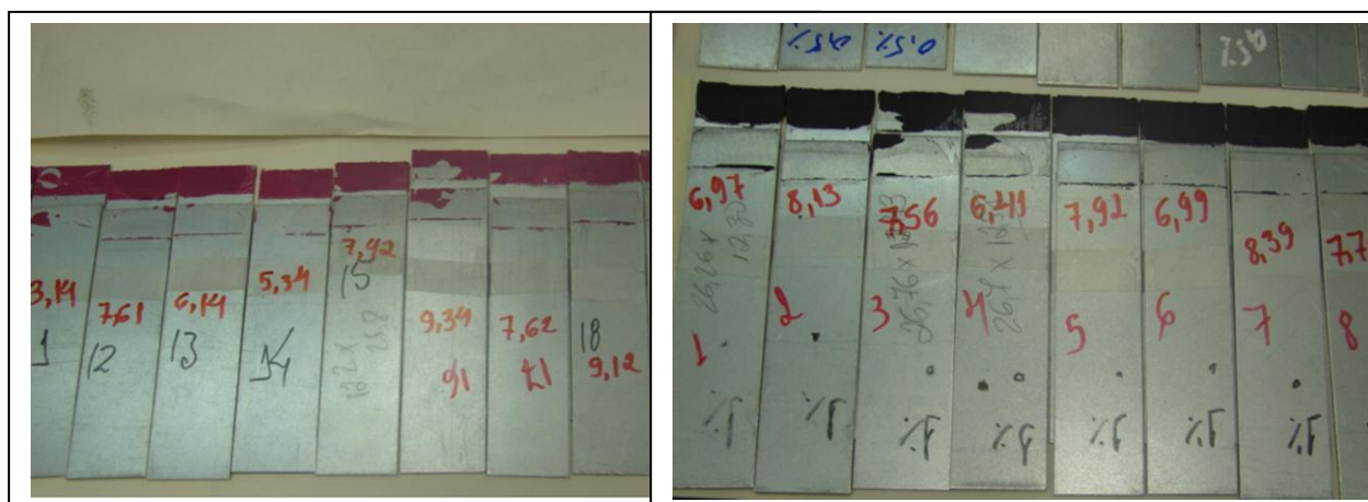
FIGS. 104 e 105 – Corpos de prova evidenciando a ruptura de caráter predominantemente adesivo para a condição Puro e 1%.
