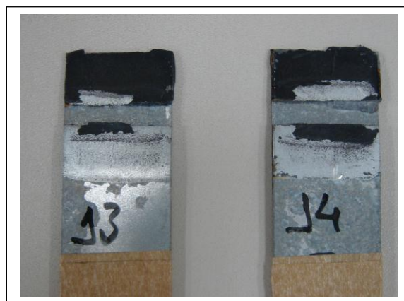
FIG.127 - Superfícies de fratura do adesivo puro e FIG.128 do nanoadesivo com 3%. FONTE LAB. FIAT
