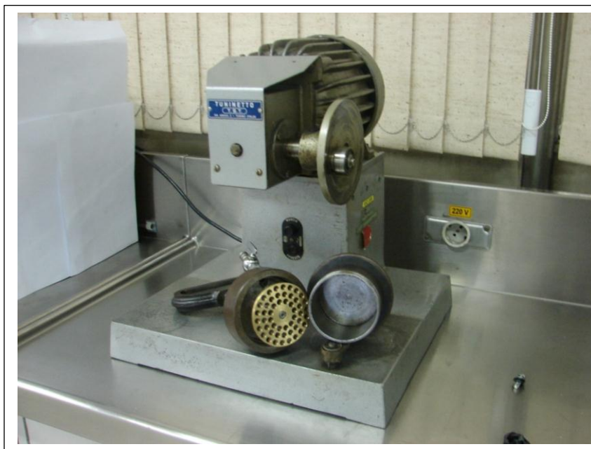
FIGURA 61 – Detalhes equipamento Grease Worker Laboratório Fiat Automóveis. FONTE – LAB. FIAT
