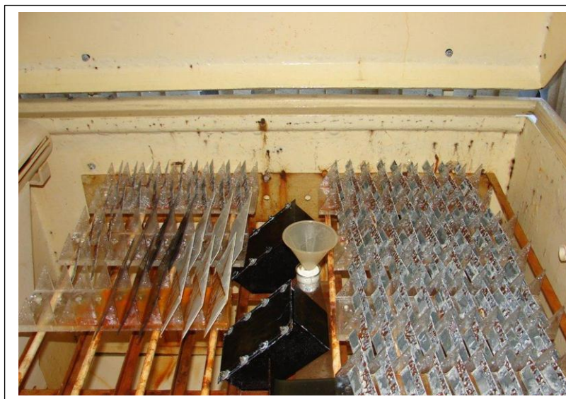
FIGURA 73 – Detalhe do interior da câmara com os corpos de prova posicionados após o ensaio FONTE – LAB. FIAT
