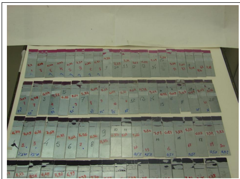
FIG.89 – Corpos de prova de cisalhamento testados. FONTE – LAB.FIAT
