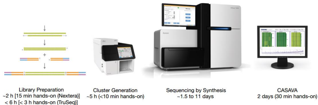
Figura 5 - Etapas do sequenciamento pela plataforma Ilumina Hiseq 2000. A etapa de análise das sequências pelo programa Consensus Assessment of Sequence and Variation (CASAVA) é opcional e softwares análogos podem ser utilizados. Fonte: Ilumina, 2011.
