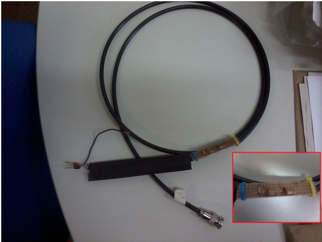
Figura 5.63: Cabo utilizado no ensaio com o filtro anti-aliasing.
