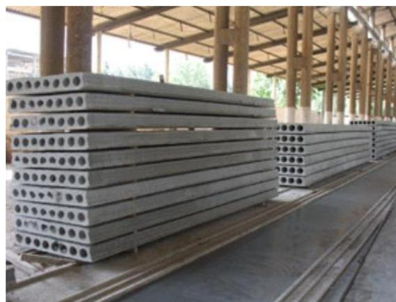
Figura 91 - Painéis Alveolares prontos para transporte.
