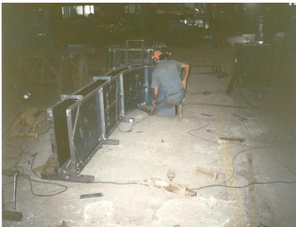
Figura 92 - Exemplo Formas Metálicas para concretagem.
