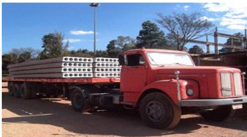
Figura 94 - Transporte dos pré-fabricados. Fonte: <http://www.r4tecnico.com.br/lajes>
