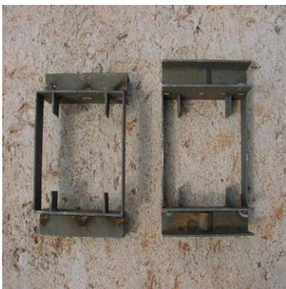
Figura 26 - Gabaritos montagem painéis.
