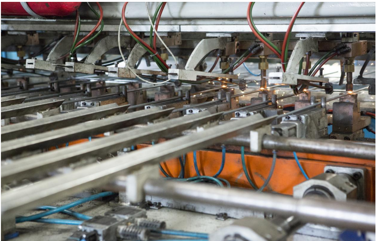
Figura 11.16: Máquina eletrostática de fusão entre os vergalhões
