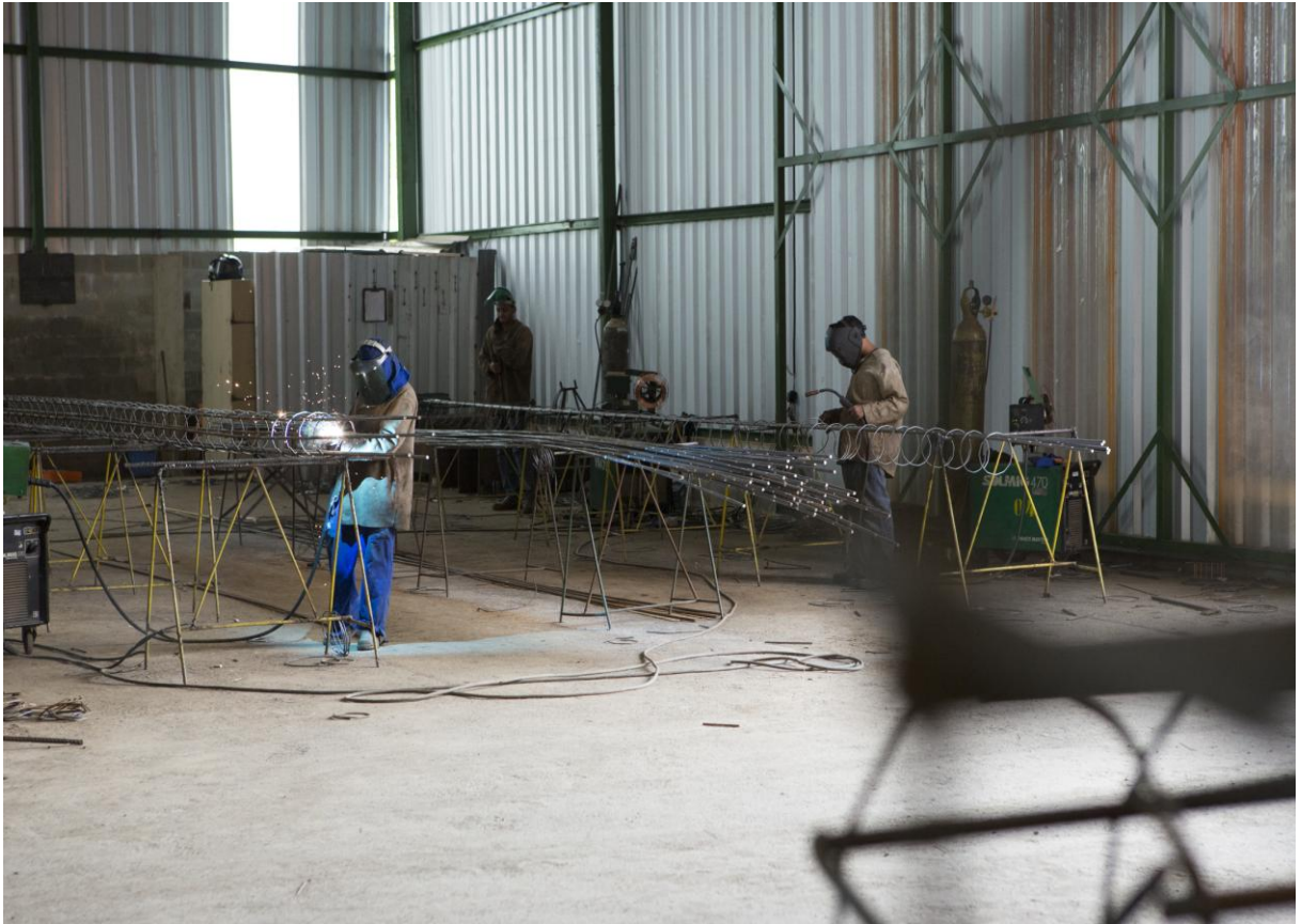
Figura 11.17: Estaca Raíz: Processo de fabricação
