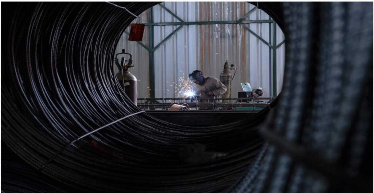
Figura 11.18: Estaca Raíz: Fabricação com solda Mig
