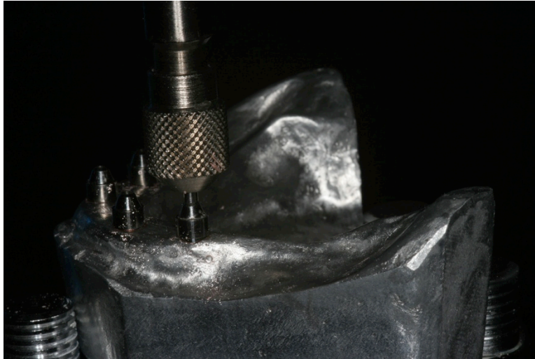
Figura 5: Instalação do análogo do minipilar na região do 45.
