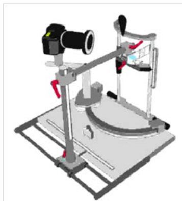
Figura 9: Dispositivo para fotografias intra-orais padronizadas.
