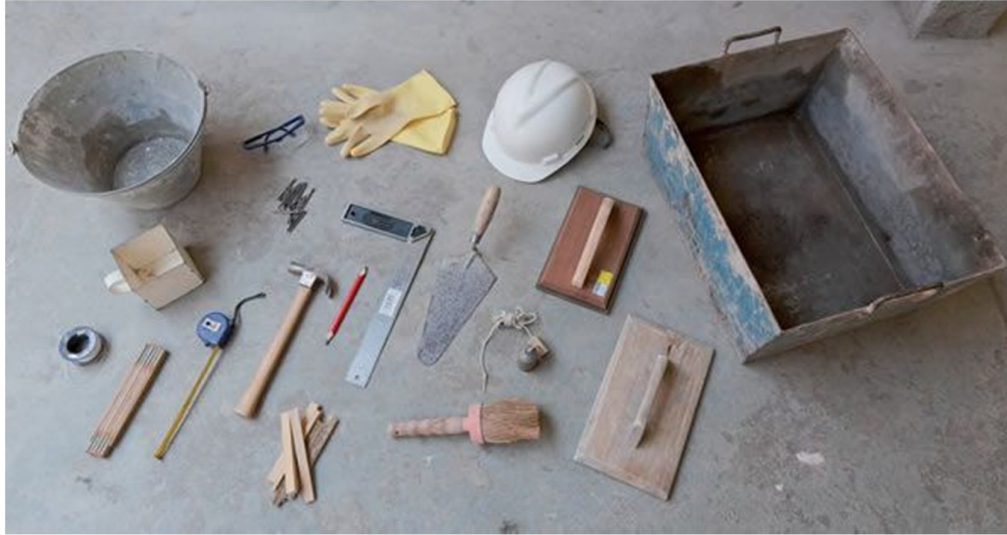
Figura 12 - Baldes, óculos, luvas, capacetes, desempenadeira, desempenadeira revestida com espuma, broxa, prumo, colher de pedreiro, esquadro, lápis, pedaços de madeira ou cerâmica (taliscas), martelo, pregos, trena, fio de náilon e caneca dosadora.
