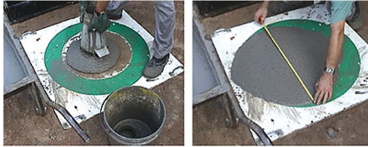
Figura 30 – Ensaio Slump Flow Test. Fonte:Revista CONSTRUÇÃO MERCADO
