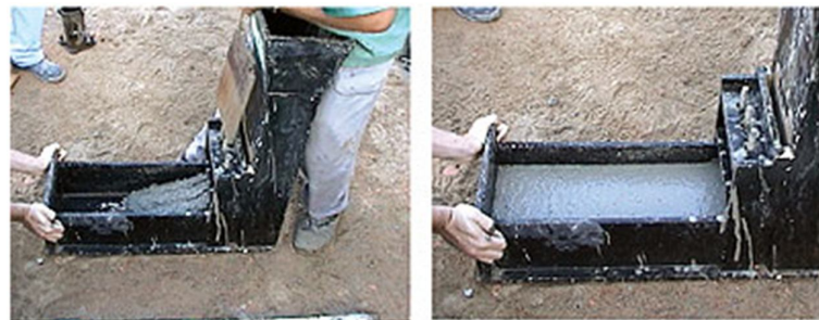
Figura 31 - Ensaio L-Box Fonte:Revista CONSTRUÇÃO MERCADO
