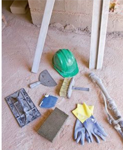
Figura 22 - Capacete, luvas, máscara, régua metálica e tipo H para sarrafeamento, broxa, desempenadeira plástica, esponja de espuma rígida e pistola do equipamento. Fonte:Revista EQUIPE DE OBRA
