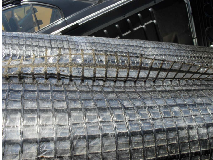
Figura 63 - Grelha de fibra de carbono embebida em betume. (Fonte: INFRAERO)
