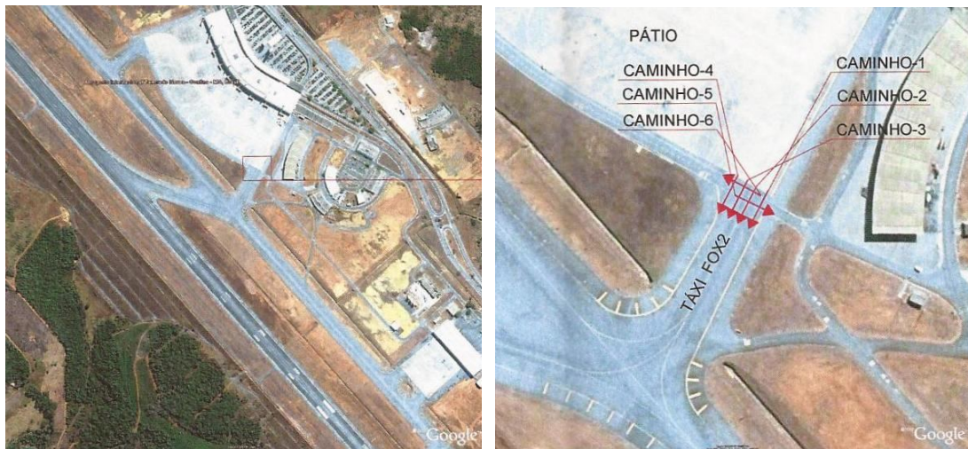
Figura 42 - Localização FOX-2 e direções de análise do GPR. (Fontes: STRATA Engenharia e INFRAERO)
