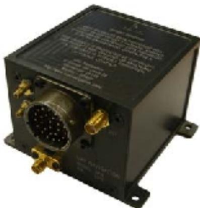
Figura 2.18: Piloto-Automático AP04 da UAV Navigation.
