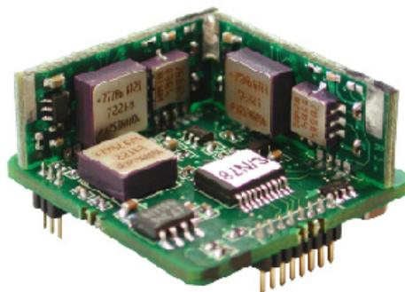
Figura 2.11: Imagem da IMU Crista da Crossbow.
