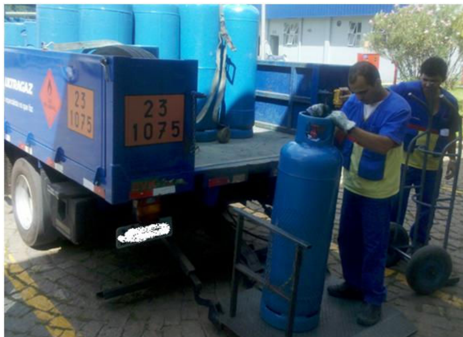
Figura 8 Plataforma hidráulica para transporte de vasilhames
