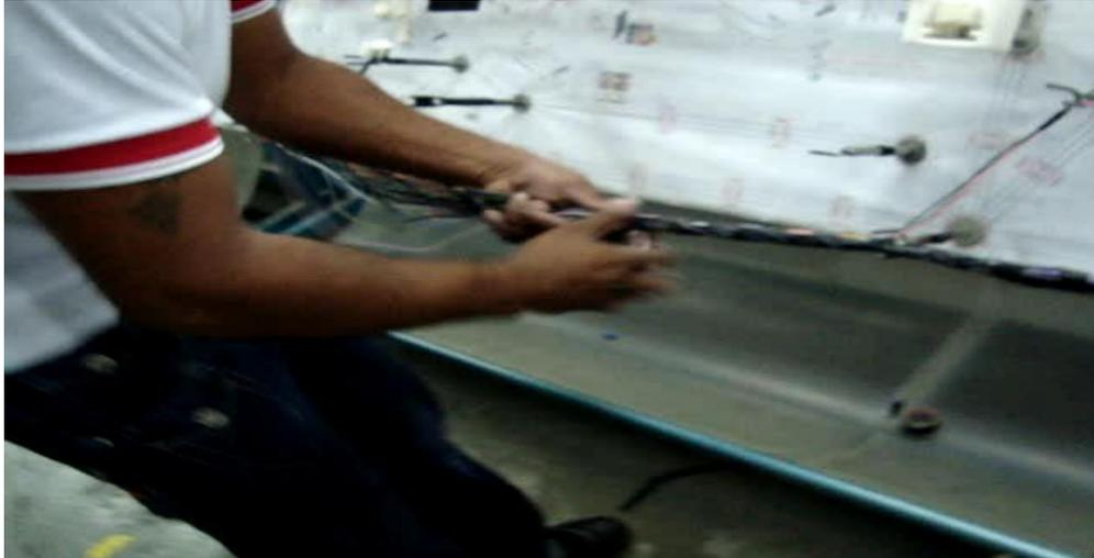
**Figura 9 – Enfitamento dos tubos na fase 4. Observe a flexão de tronco do trabalhador. Fonte: fotografias colhidas pelo autor.**
