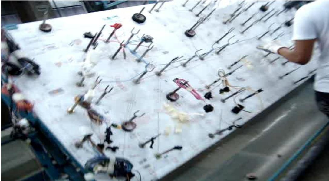
**Figura 6 – Posicionamento dos módulos na parte lateral e inferior da mesa e início da distribuição dos módulos na fase 1. Fonte: fotografias colhidas pelo autor.**
