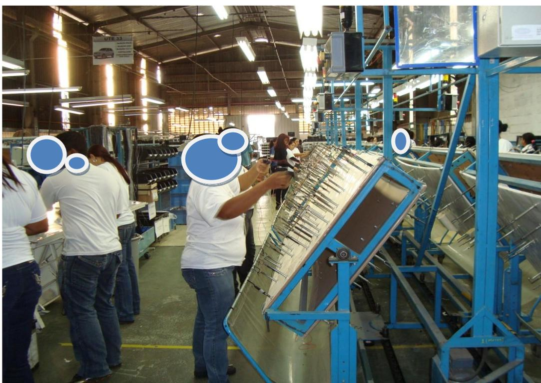
**Figura 1 – Trabalhadores posicionados em frente às mesas da linha de montagem (*conveyor*): agrupamento dos componentes e circuitos. Fonte: fotografias colhidas pelo autor.**
