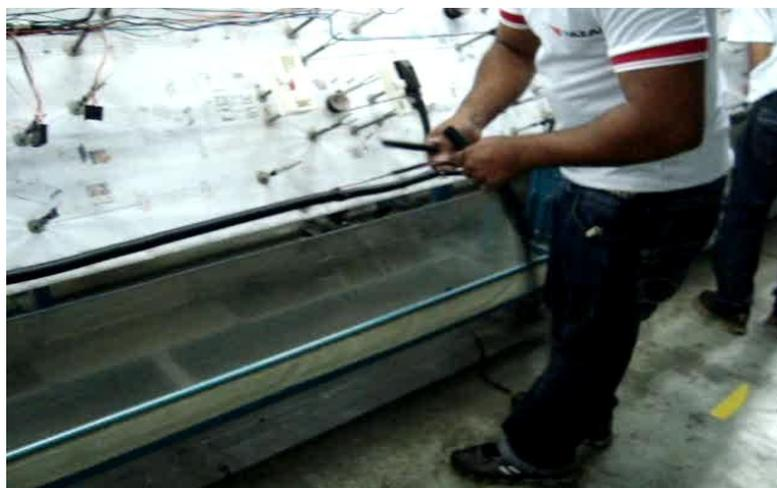
**Figura 10 – Colocação dos tubos corrugados na fase 4. Fonte: fotografias colhidas pelo autor.**
